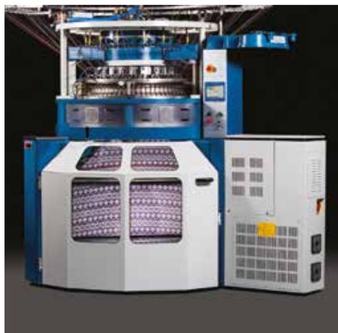
Tradicional basamento Orizio modular, renovado na funcionalidade, robustez e estética com novo painel de controle integrado que permite a utilização de novas tecnologias e integra o controle máquina, a seleção agulha-agulha e as seguintes funções:
