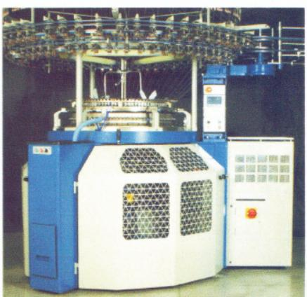
Tradicional basamento Orizio modular renovado na funcionalidade, robustez e estética com novo painel de controle "FUTURE" integrado que permite a utilização de novas tecnologias e integra uma IHM (Interface Homem Máquina) com um controlador CLP (Controle Lógico Programável).
